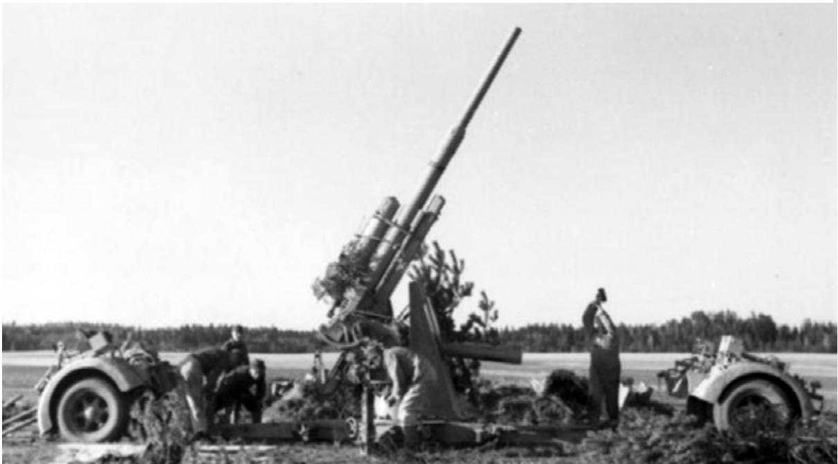
Abb. 04b: Eine „Achtacht“, feuerbereit aufgestellt als Flakgeschütz. Quelle: BArch Bild 101I-724-0135-16 / Briecke / CC-BY-SA 3.0
