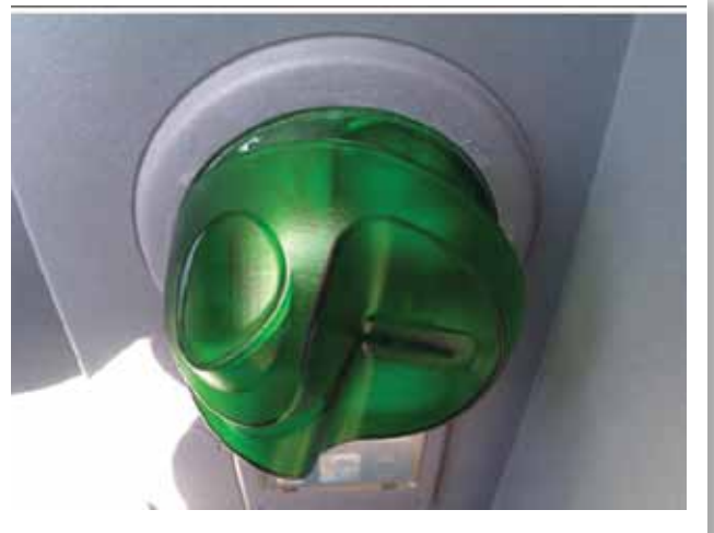
Wieħed mill-aħħar skimmers li twaħħal fuq ATMs iktar moderni
