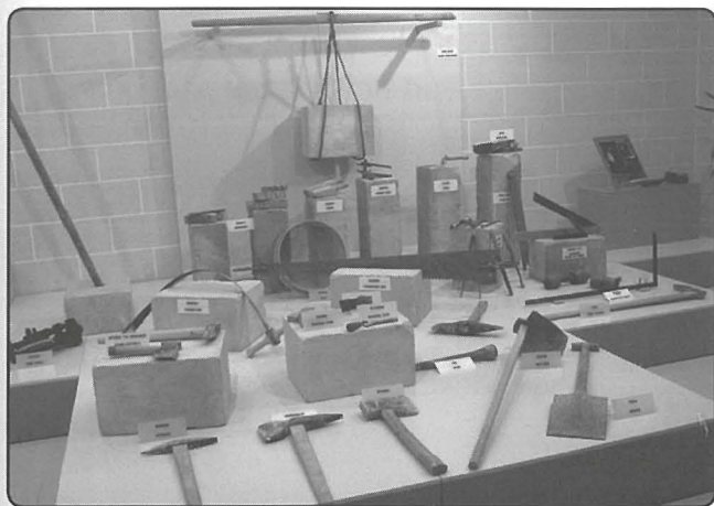
Għodod differenti li kienu jintużaw għall-qtagħ tal-gebla tal-franka fil-barriera.
