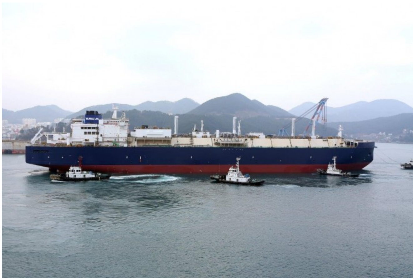
SCF Yamal/ Christophe de Margerie, the first Arc-7 Ice Classed LNG carrier. (IHS)
