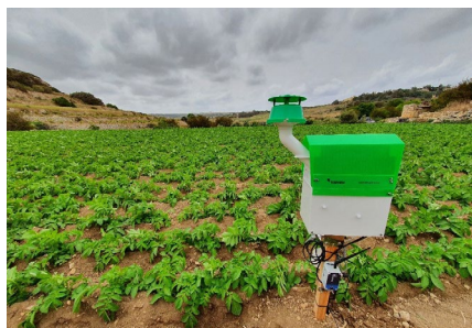
Fig. 2 Teknoloġija li giet żviluppata biex tidentifika l-preżenza ta' insetti li jagħmlu l-ħsara
