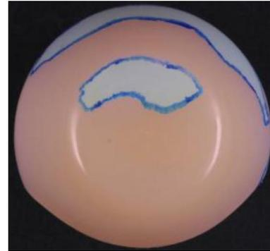
(d) Rotator (external surface): experimental contact status.
