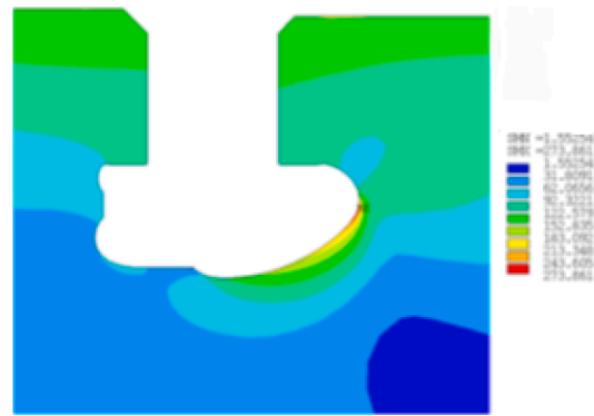
Fig. 13.. HP Blade 1 groove, max Von Mises stress.
